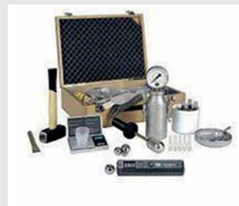
Fig. 2.3 - Trusă pentru măsurarea umidității cu carbură de calciu (carbide CM)
